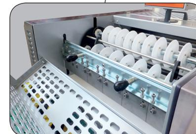
Cylindre avec 4 jeu des disques de différente largeur
