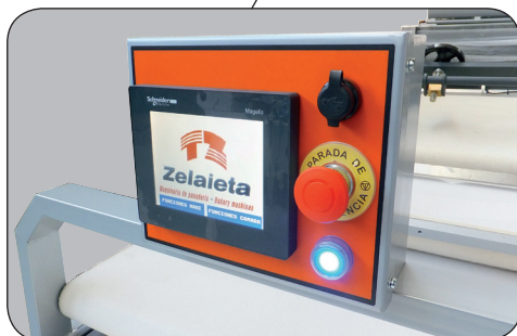
Cuadro control mediante autómat
