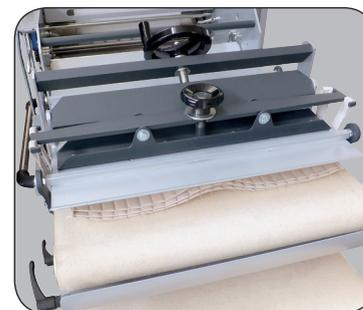
Estirado mediante plancha regulable, así como sistema "pan con puntas" también regulable.
